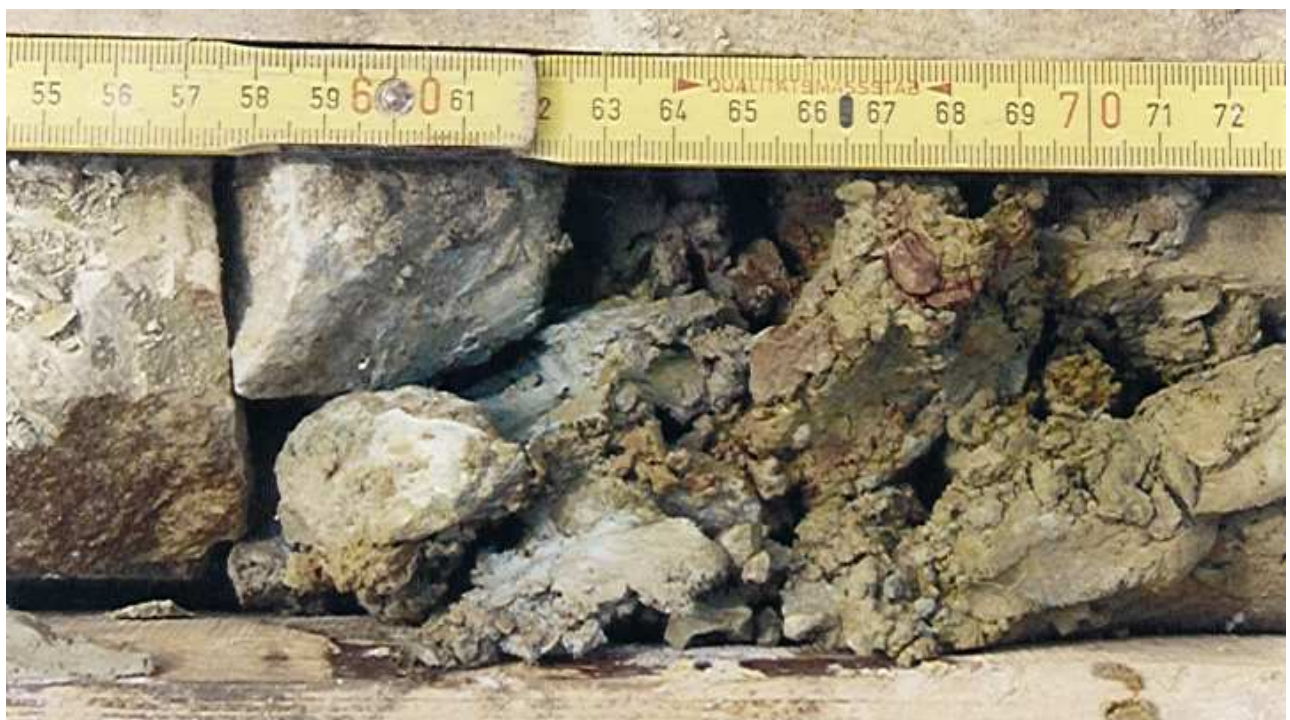
Abb. 3: Plastischer Ton und Felsbruchstückchen (aus Mergel, Silt- und Sandstein) an der Gleitfläche
