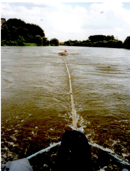
Foto 2: Meßstrang für geoelektrische Widerstandstiefensonierungen an der Gewässeroberfläche
