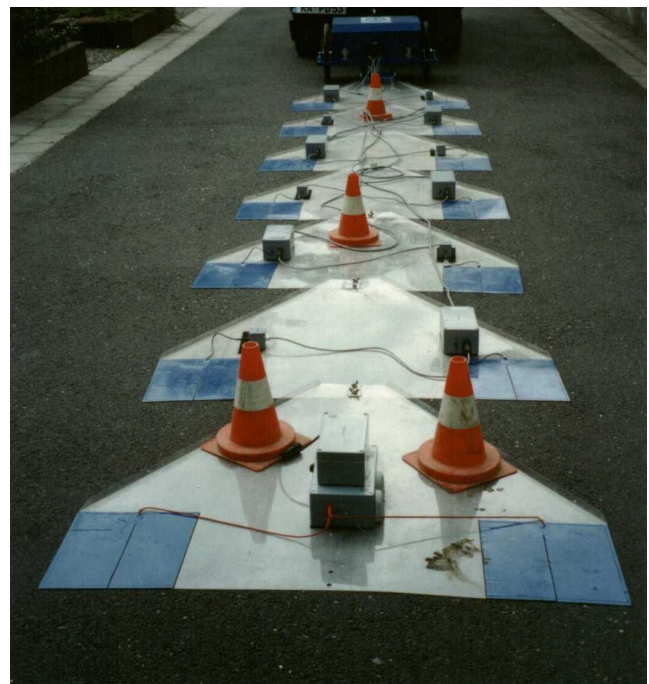
Abb. 4: Meßgerät für die kapazitive goelektrische Dipol-Dipol-Kartierung (Tomographie)
